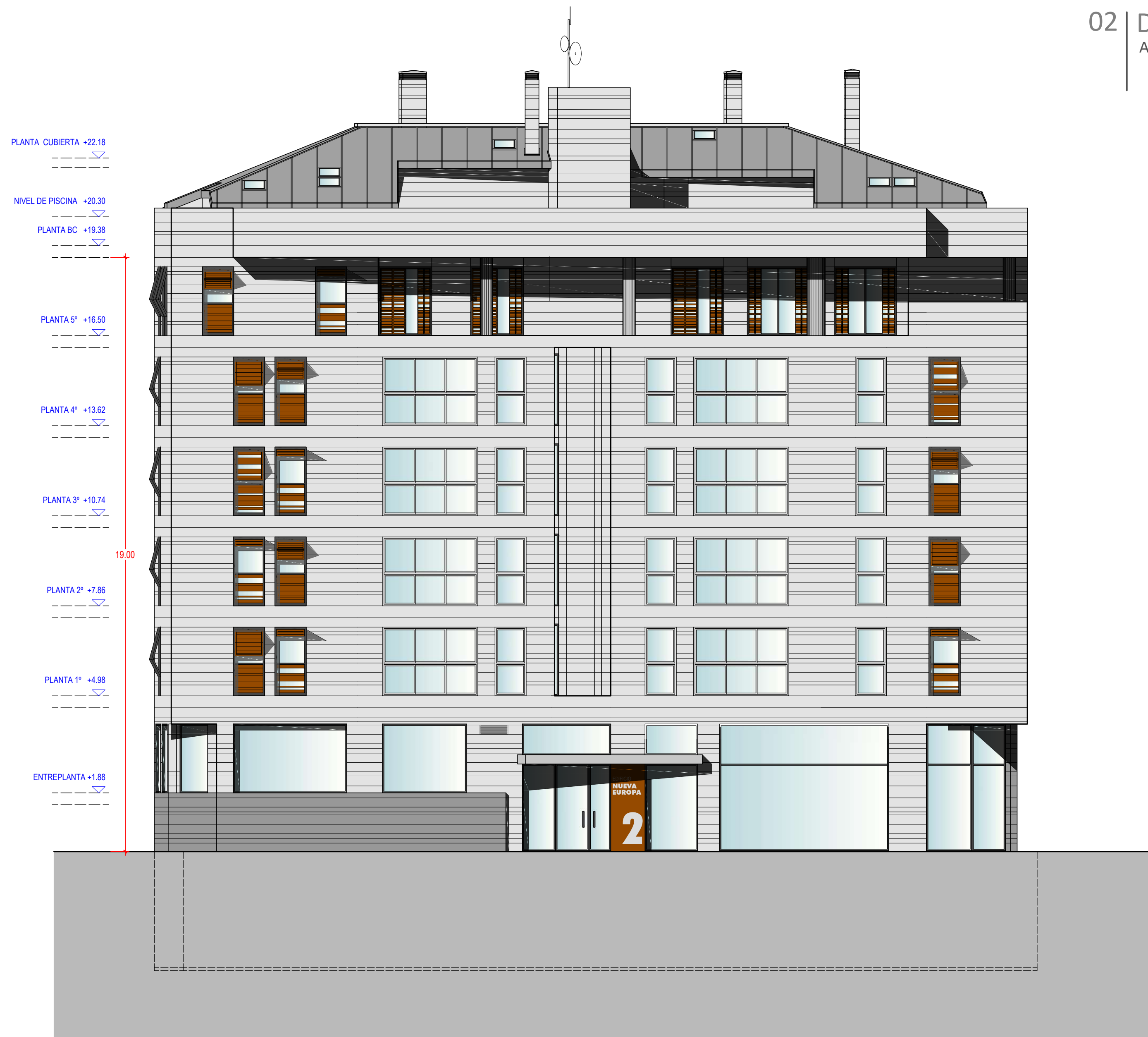
Alzado 1. Sin fachada flotante.
